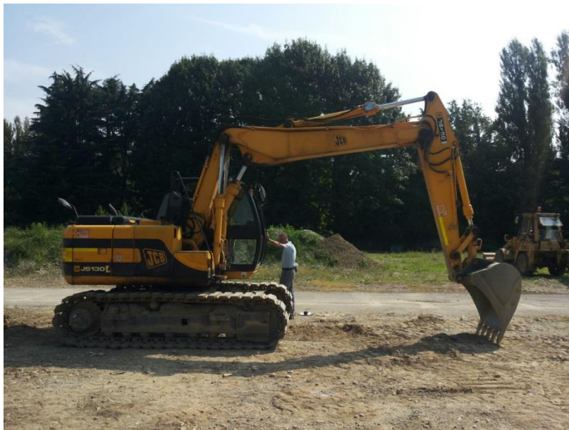
Escavatore Cingolato JCB JS 130
